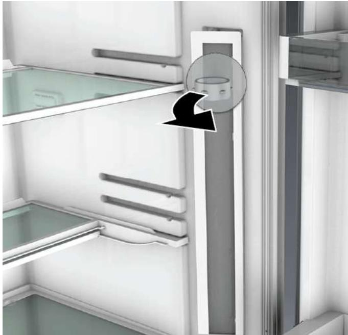
3. Staccare il collegamento della luce a barra laterale a LED.
