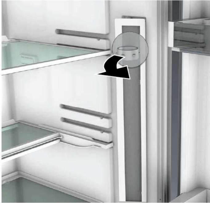
3. Haal de elektrische aansluiting van de LED-zijlichtbalk los.
