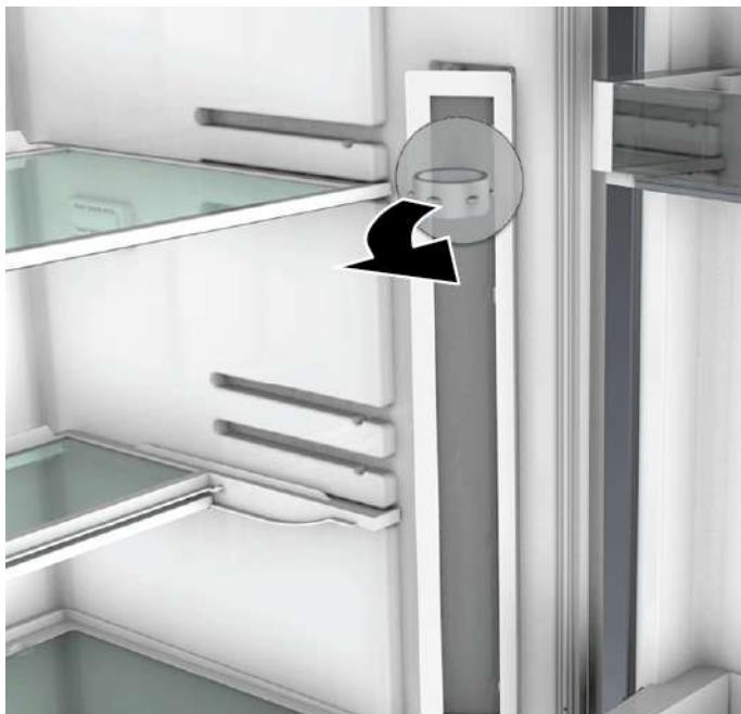
3. Desconecte a ligação elétrica da iluminação LED de barra lateral.
