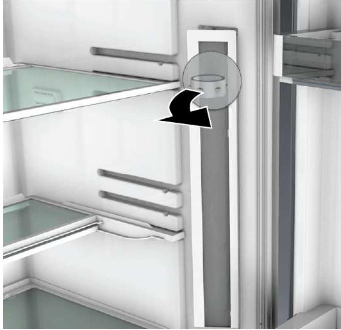
3. Deconectați conexiunea electrică a lămpii LED de pe bara laterală.
