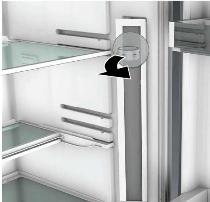
3. Den elektrischen Anschluss der seitlichen LED-Beleuchtung trennen.
