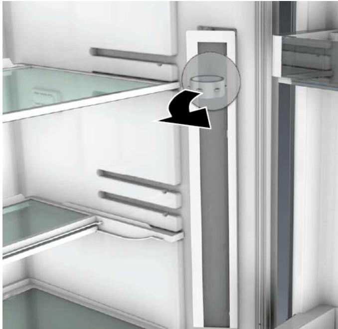
3. Odvojite električni priključak od LED svjetlosne šipke.
